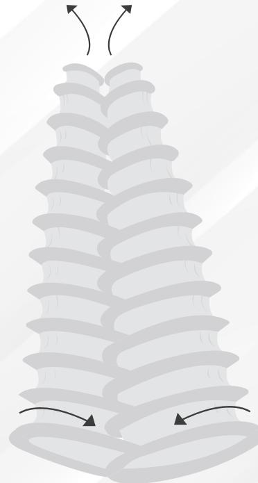
En la imagen anterior se puede observar el proceso de compresión. En la salida, una vez que el aire se ha comprimido, debe haber una válvula de salida (outlet valve) la cual alimenta esa mezcla de aire con aceite hacia el filtro separador.
